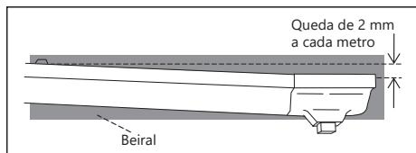
De esta manera las boquillas quedarán en el punto más bajo del sistema, y entonces no tendrá agua parada dentro de la canaleta.
