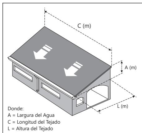
Para tejados con inclinación de hasta 20° el área máxima por bocal (AMT) que la canaleta puede agotar en las principales regiones es lograda a través del cálculo sobre la Intensidad Pluviométrica (IP).
