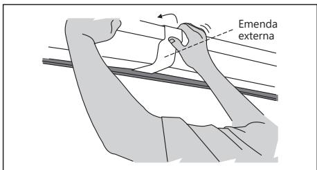
Caso deseje, parafuse a aba da emenda na calha orientando-se pelas marcações na peça.
