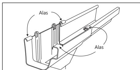
Note que este encaje permite el movimiento de la canaleta dentro de la boquilla de salida. Esta libertad de movimiento es necesaria para absorber la dilatación y contracción de la canaleta, que naturalmente ocurre con la variación de temperatura ambiente.
