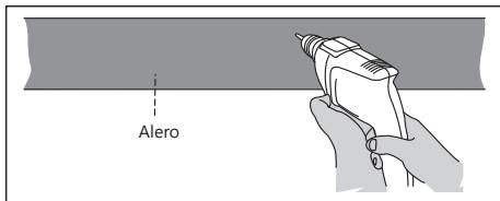
Inicie la fijación dejando el ultimo soporte suelto para que sea posible acoplar el próximo módulo. Si necesario, mantenga esta extremidad suspensa por un pedazo de cordel.
