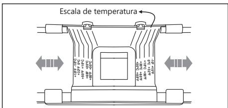
Los dos modelos del bocal contienen las mismas características en su formación (alas de fijación y formato) y el proceso de instalación es el mismo.
