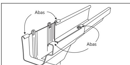
Note que este encaixe permite a movimentação da calha dentro do bocal de saída. Esta liberdade de movimento é necessária para absorver a dilatação e contração da calha, que naturalmente ocorre com a variação da temperatura ambiente.
