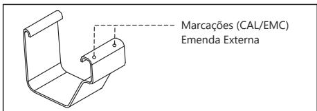
**União utilizando CAL/EMS:** Composta por uma peça (imagem acima) deve ser utilizada, da seguinte forma:
