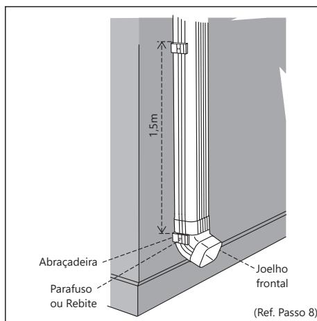
Inicie a fixação deixando o último suporte solto para que seja possível acoplar o próximo módulo. Se necessário, mantenha esta extremidade suspensa por um pedaço de barbante.
